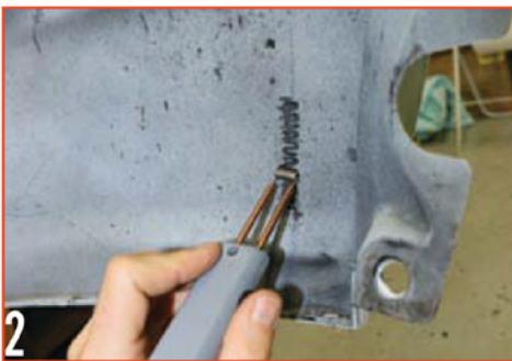
2 Introduire Plastic Smart Smoother dans le manipulateur et le faire coulisser au-dessus de la partie traitée. Insert Plastic Smart Smoother in the torch and slide it over the welded part.
